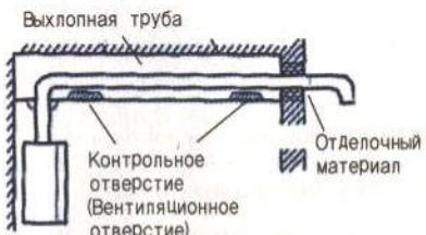
► Во избежание утечкиовых лопных газов соединительные участки должны быть прочно скреплены и покрыты огнеупорным материалом, за исключением металла, а также жаростойким кремнем.
