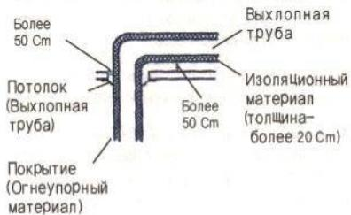
► При удлинении дымовой трубы следует устанавливать ее таким образом, чтобы избежать свисания
