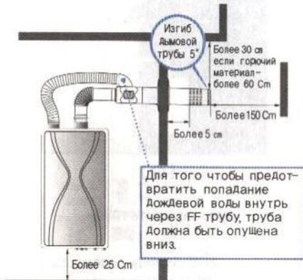
❶ Горизонтальную часть выхлопной и воздухозаборной трубы устанавливать под углом 30° вниз с тем, чтобы в котел не попадала дождевая вода, и не образовывалась конденсат.
