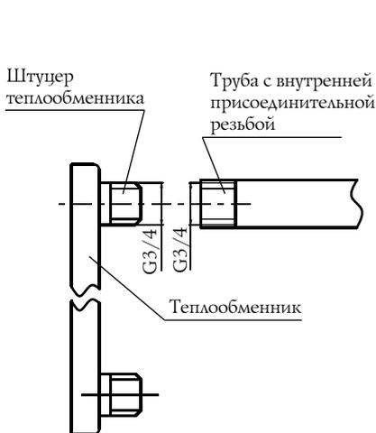
Рисунок 9. Присоединение трубопровода напрямую.
