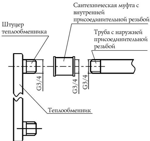
Рисунок 10. Присоединение трубопровода через муфту.
