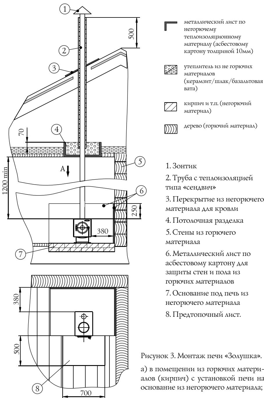
Рисунок 3. Монтаж печи «Золушка».
