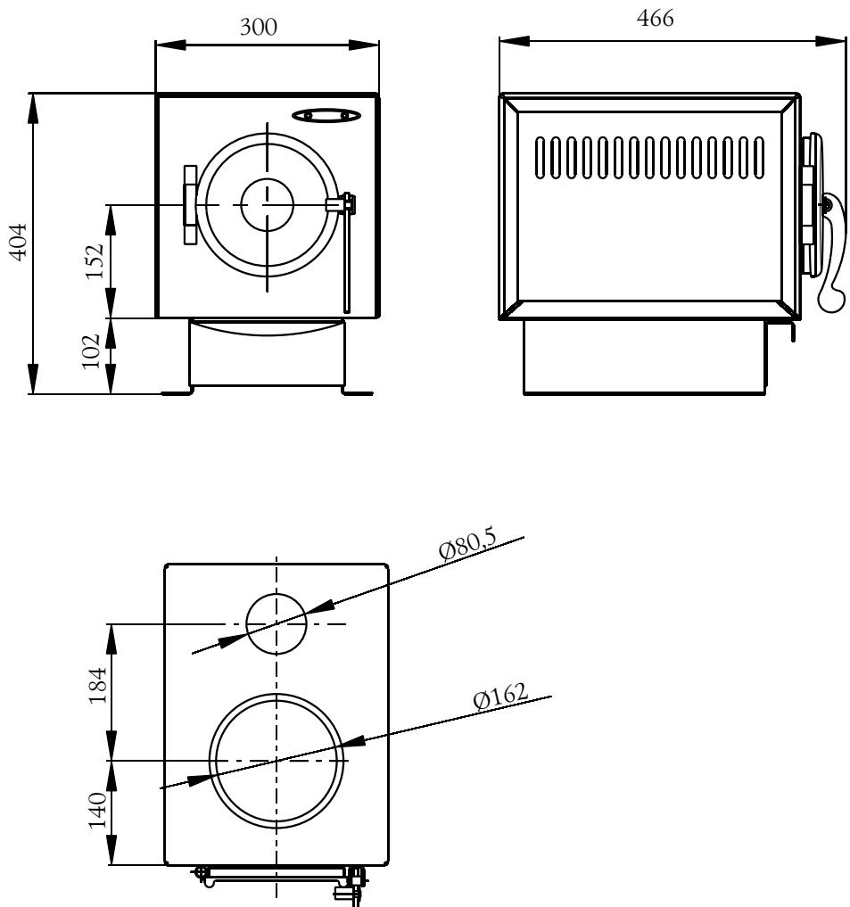
Рисунок 1. Габаритные размеры печи «Золушка».
