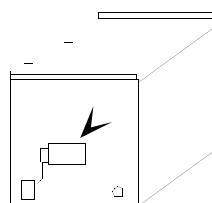
Насос должен располагаться рядом с полом, как можно ближе к баку для хранения топлива.
