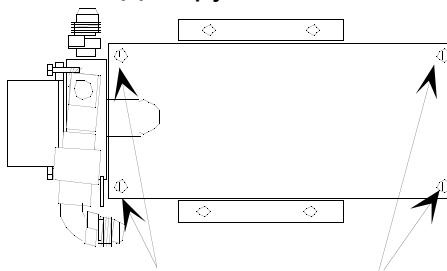
Снимите винты крышки, после чего снимите саму крышку.
