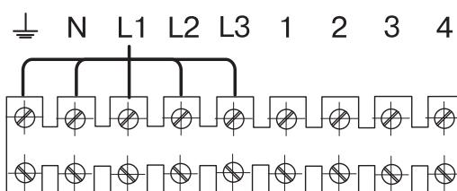
Рис. 5. Схема подключения BHC-9 SR(N)
